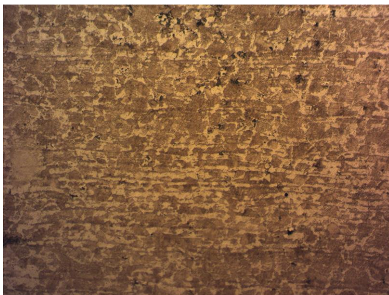
Figura 19 – Microestrutura do material como recebido: corte transversal, visto pelo microscópio óptico, no aumento de 200x
