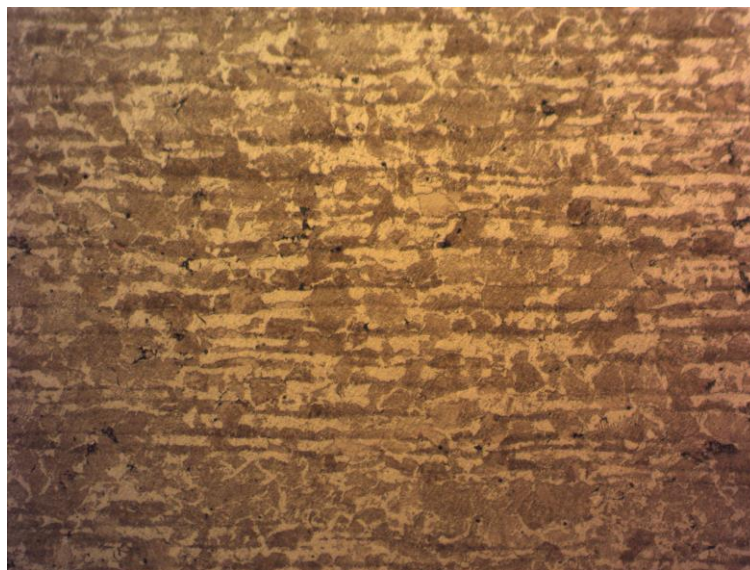
Figura 16 – Microestrutura do material como recebido: corte longitudinal, visto pelo microscópio óptico, no aumento de 200x
