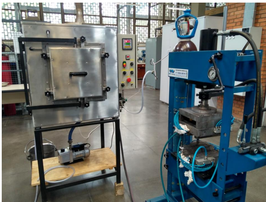
Figura 14 - Conjunto utilizado nos ensaios (forno à esquerda e prensa hidráulica à direita)
