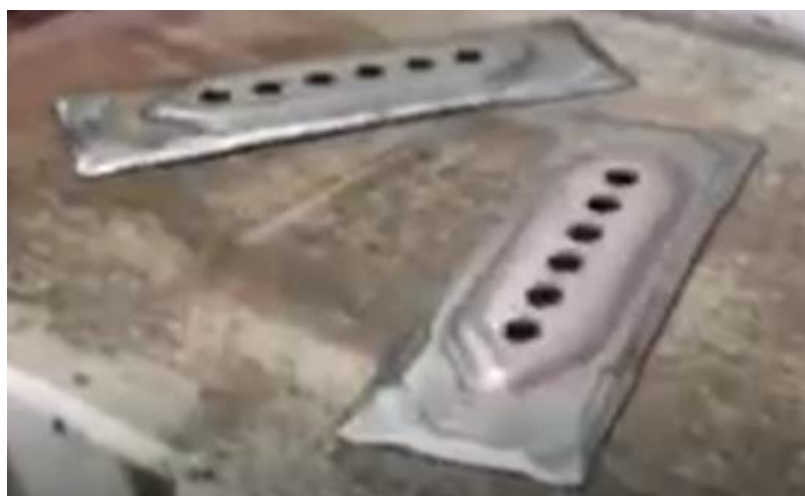
Figura 5 – Facas utilizadas no corte basal, durante seu processo de fabricação
